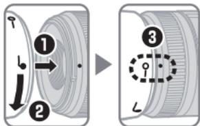
Ευθυγραμμίστε το σημάδι ασφάλειας σκίαστρου φακού (—○) με το σημάδι τοποθέτησης σκίαστρου φακού (●) στον φακό (③).
