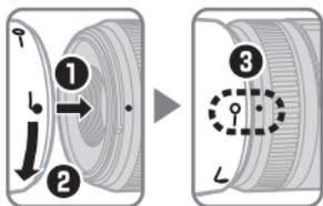
Zarovnajte značku aretovanej polohy slnečnej clony objektívu (—○) s upevňovacou značkou slnečnej clony objektívu (●) na objektíve (③).
