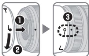
Richten Sie die Markierung für die Arretierung der Gegenlichtblende (—○) an der objektivseitigen Markierung für das Ansetzen der Gegenlichtblende (●) aus (3).
